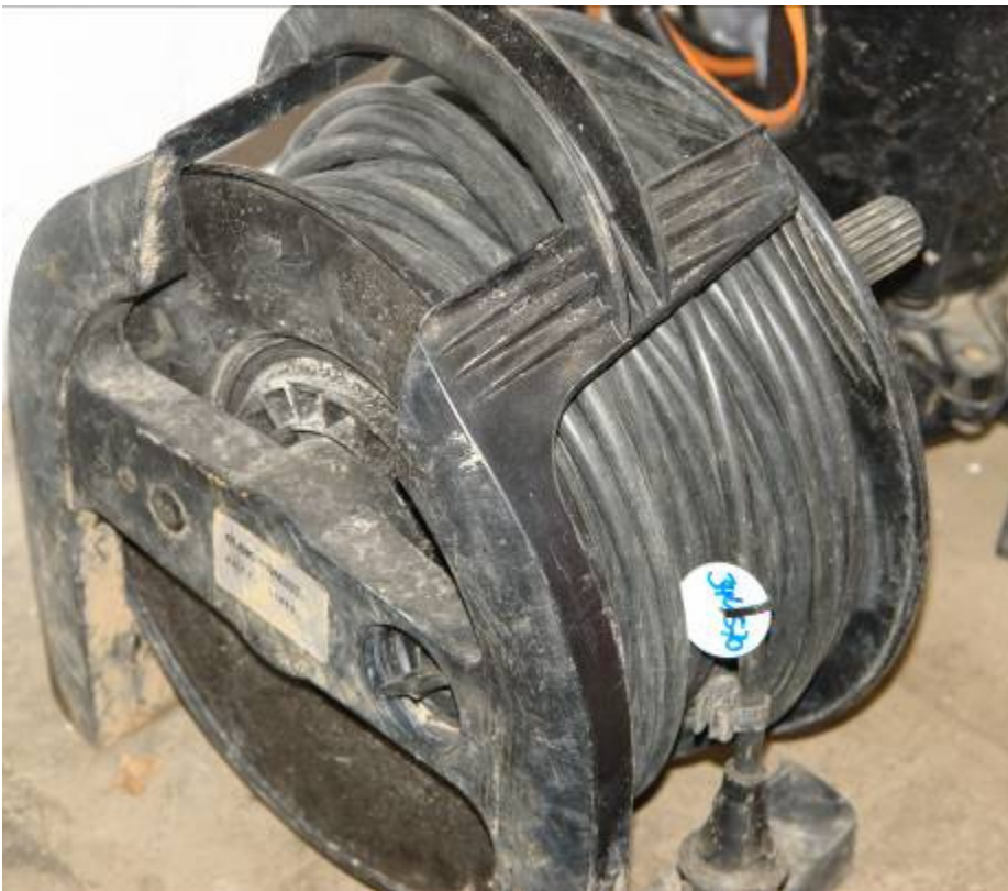
RFID-Chip (runde weiße Plakette) an einer Kabeltrommel.
