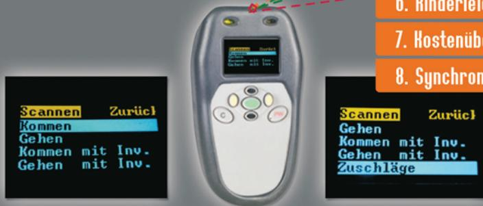
Erfassung der Mitarbeiter per RFID oder Barcode auf Baustelle. Scanner wird in ein Fahrzeug mit mobileObjects GPS-Datenbox eingesteckt. Die Daten werden sofort übertragen und stehen zur weiteren Nutzung bereit. Durch die GPS-Box erhält die gescannte ID-Nummer zusätzliche Informationen, wie z.B. Adresse oder Kostenstelle.
