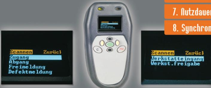
Erfassung der Geräte und Maschinen per RFID oder Barcode auf Baustelle. Scanner wird in ein Fahrzeug mit mobileObjects GPS-Datenbox eingesteckt. Die Daten werden sofort übertragen und stehen zur weiteren Nutzung bereit. Durch die GPS-Box erhält die gescannte ID-Nummer zusätzliche Informationen, wie z.B. Adresse oder Kostenstelle.
